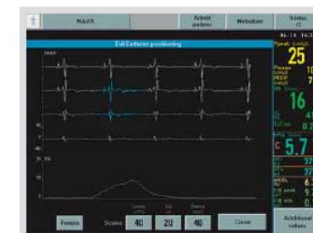
Wenn der Katheter richtig positioniert ist, sollte eine deutliche P-Welle im obersten Kanal mit einem kontinuierlichem Abfall der P-Wellenamplitude auf den unteren Ableitungen erkennbar sein.
